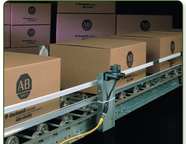
Malzeme taşıma uygulaması – Bir konveyör hattında paketleri algılayan ışığı geri yansıtan RightSight.
