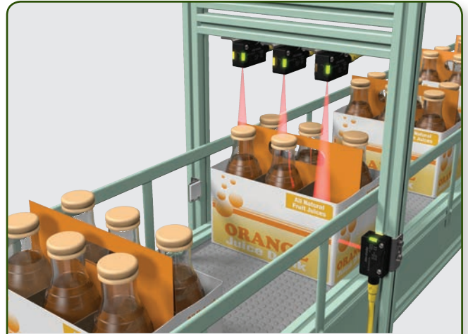
Şişeleme kontrolü – Konveyörün yan tarafına monte edilmiş olan tek bir 42JT LaserSight şişe kartonunu tespit ettiğinde, eksik şişeleri kontrol etmek için yukarıdaki üç standart VisiSights'ı tetikler.
